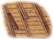
Abb. 15: Spezielle Balkenkonstruktionen sind geeignet zur Schaffung von Quartieren
