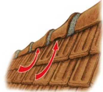
Abb. 23: Einflug über Firstziegel
