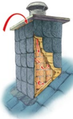
Abb. 43: Ein Schornstein kann noch nachträglich verkleidet werden und als Fledermausquartier nutzbar gemacht werden
