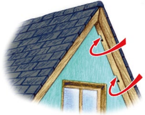
Abb. 21: Einschluflmöglichkeit im Ortgang
