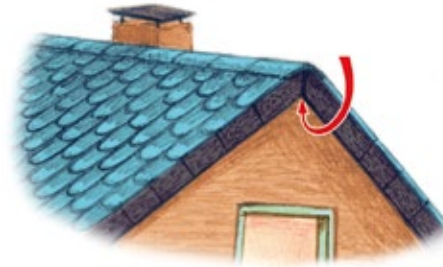
Abb. 18: Einflugmöglichkeit in das Unterdach über offenen Dachüberstand
