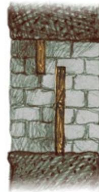
Abb. 26: Einflugmöglichkeit für Fledermäuse unter Ausschluss von Tauben
