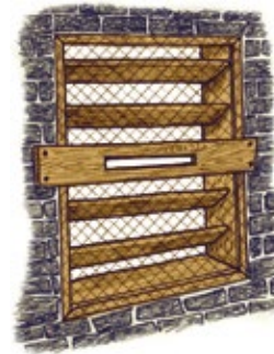
Abb. 26: Einflugmöglichkeit für Fledermäuse unter Ausschluss von Tauben
